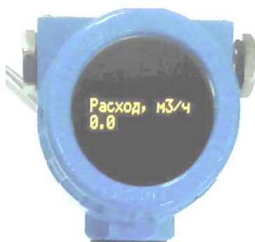
Рисунок 2 – Электронный преобразователь ЭП с цифровым индикатором
